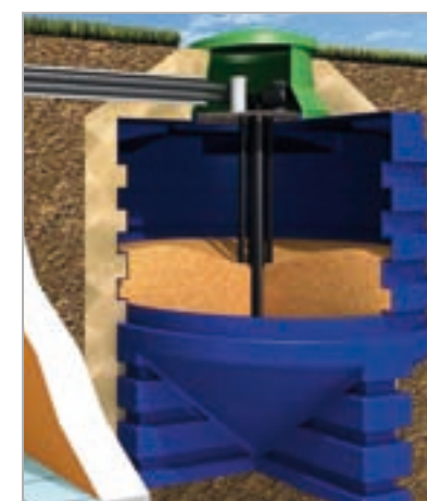
Serbatoio interrato con impianto di aspirazione
